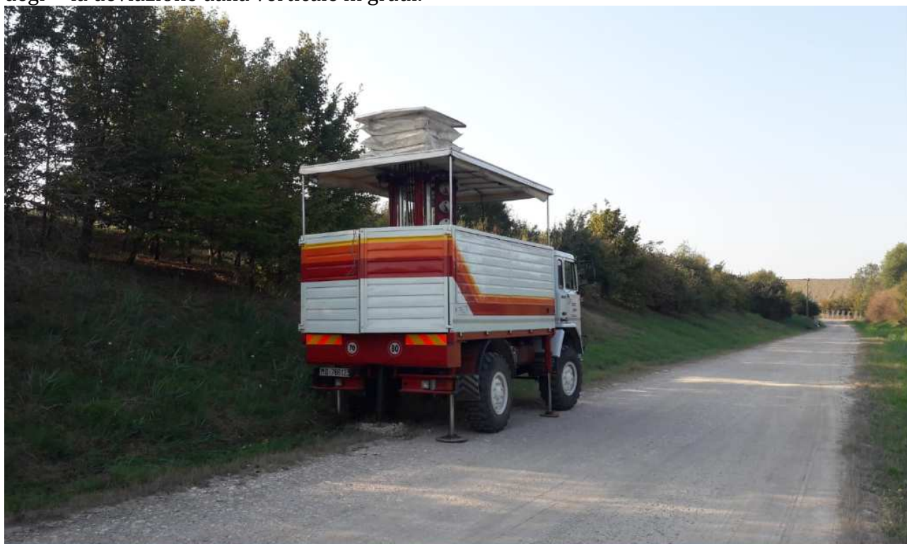
Fig.18. Penetrometro statico da 300 KN, montato su camion IVECO utilizzato in sito per l'esecuzione delle prove CPT e CPTU
